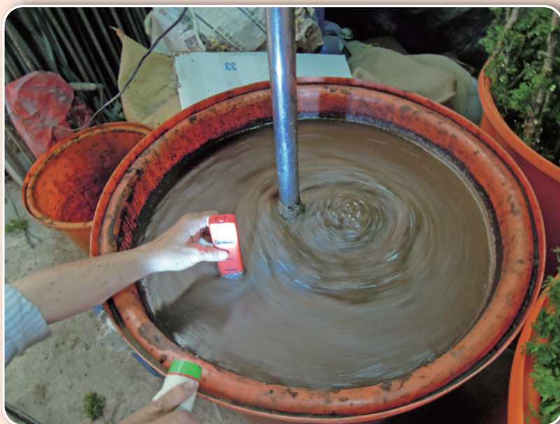
圖 4-2 定期測定電導度 (EC) 值可了解液肥中之鹽分含量是否過高
