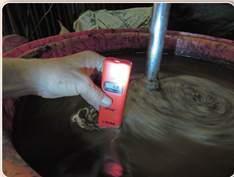
圖 4-3 定期測定酸鹼度 (pH) 值可了解液肥是否持續酸化
