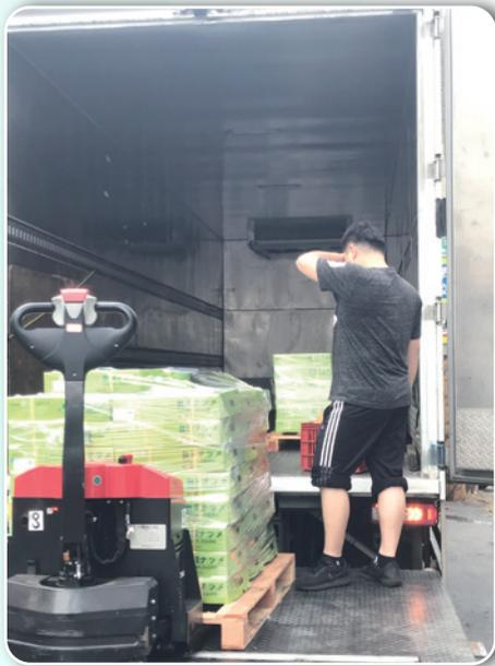
圖 3-29 預冷後之果實利用低溫運輸車貯運，避免斷鏈回溫
