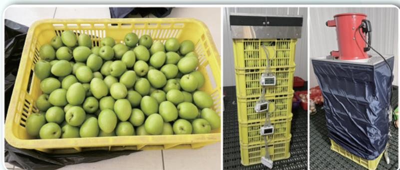
圖 3-21 小型頂吸式壓差預冷機作業，每次預冷量約可 80-100 公斤
