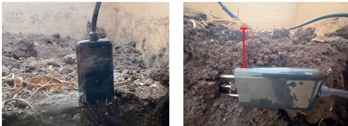
圖3 感測器安裝方式：左圖為垂直插法；右圖為水平插法。
