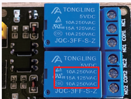
圖4 繼電器規格，須注意紅框內的電壓與電流的範圍
